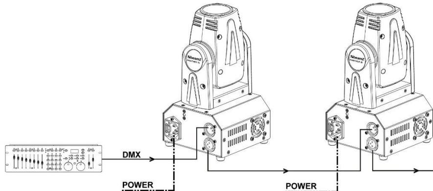
**ATENCIÓN!** En el último aparato, debe cerrar la línea DMX con una resistencia de terminación. Tome un conector XLR y suelde una resistencia de 120 Ohm entre la señal (-) y la señal (+) y conéctela a la salida DMX del último dispositivo en la línea.
