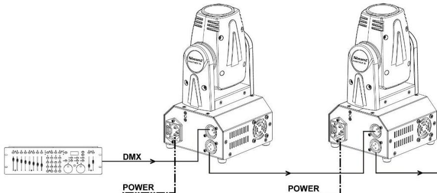
**UWAGA!** Na ostatnim urządzeniu musisz mieć linię DMX z rezystorem końcowym. Weź złącze XLR i przyłóż rezystor 120 Ohm między sygnałem (-) a sygnałem (+) i podłącz go do wyjścia DMX ostatniego urządzenia w linii.
